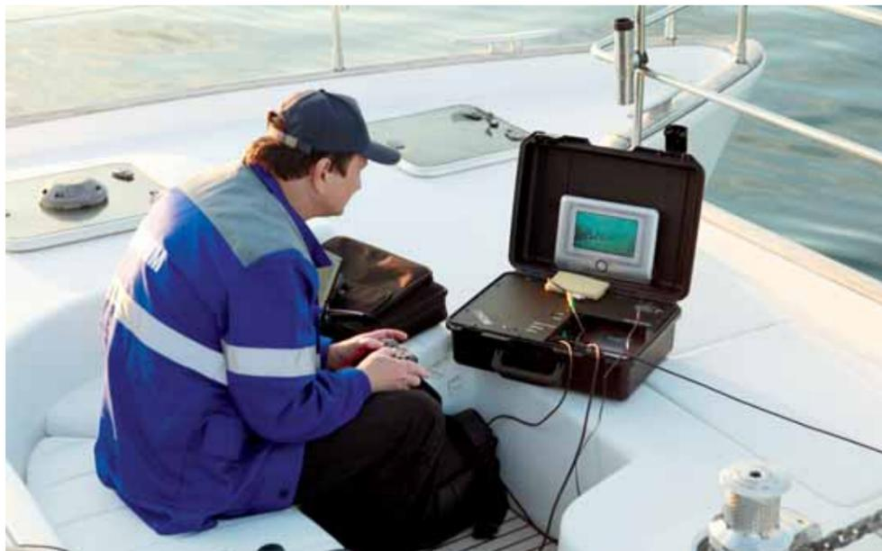
Обследование газопровода также производили с помощью телеуправляемого аппарата «Гном», изготовленного в ИТЦ. Фото: В. Апрельков.
