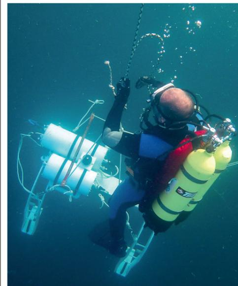
Аппаратную часть комплекса погружают в воду для обследования участка газопровода
