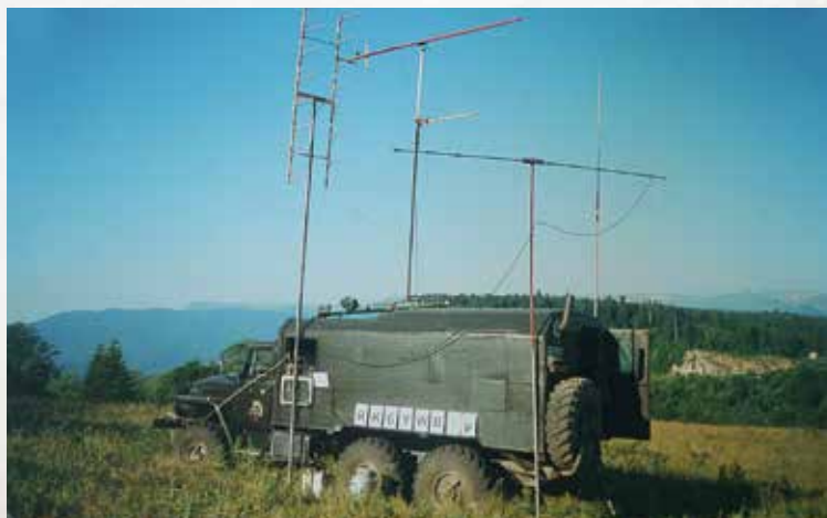
Автомобиль связи, развёрнутый для обеспечения радиосвязью.
