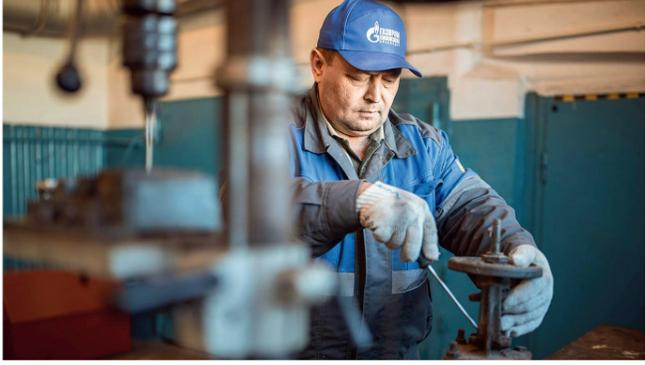
Олег Баляба, слесарь-ремонтник 5 разряда, ремонтирует запорную арматуру теплотрассы Управления технологического транспорта и спецтехники. Это позволит обеспечить безаварийную работу системы отопления в осенне-зимний период
