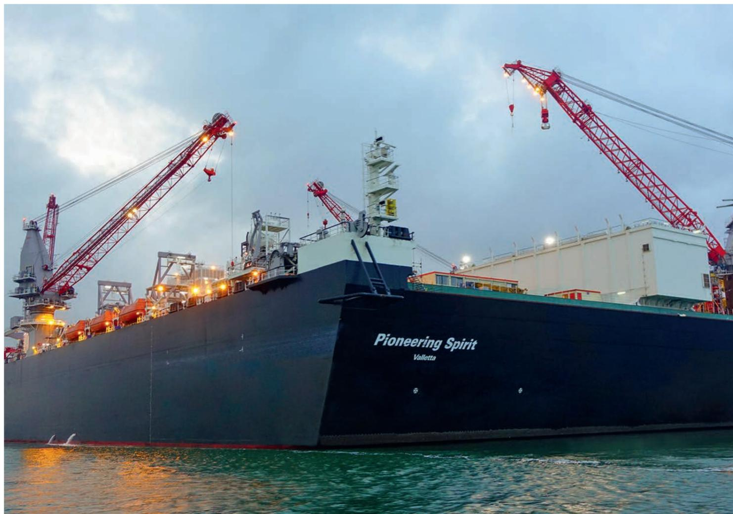
Allseas планирует задействовать для прокладки газопровода крупнейшее в мире строительное судно Pioneer Spirit, оснащенное шестью установками для сварки и нанесения покрытия
