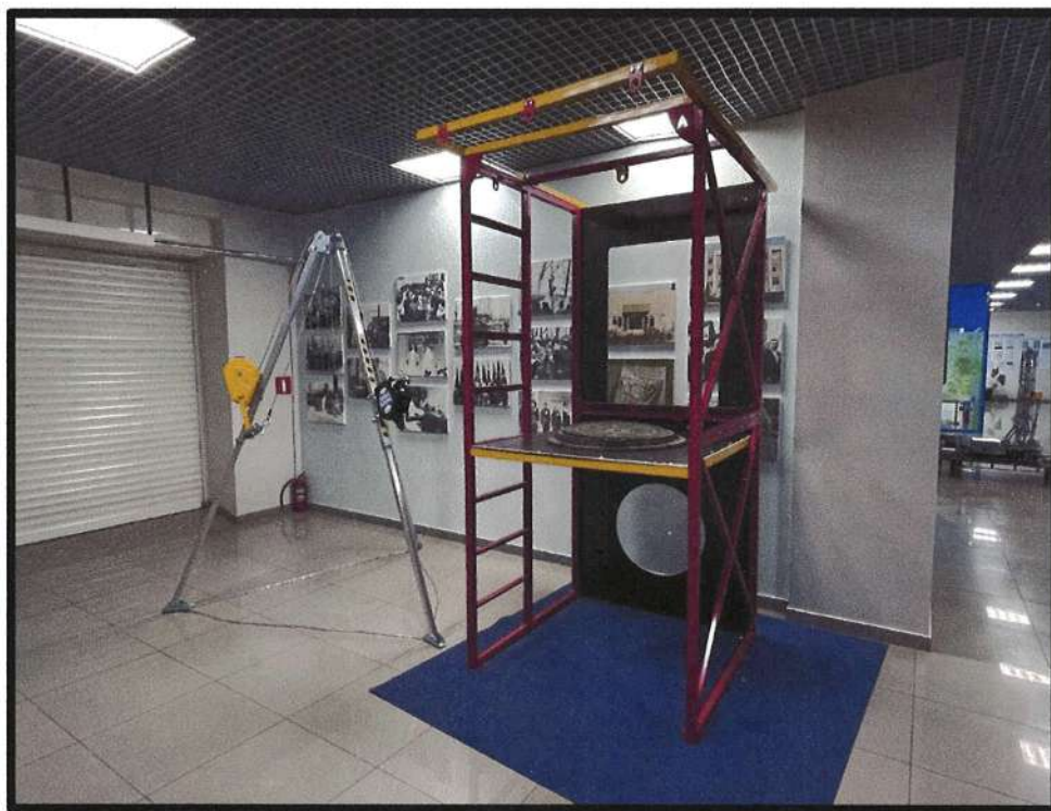
Рисунок № 7. Учебный тренажер отработки навыков работ на высоте и в замкнутых пространствах
